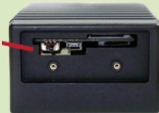
El SWITCH de encendido/carga deberá permanecer en la ubicación en la que se entrega el equipo (a la izquierda del equipo) para asegurar su correcto funcionamiento, durante las cargas este switch puede ser cambiado para agilizar el tiempo de carga (con esto el gps se apagará totalmente y podrá cargarse con más facilidad) Es importante colocar el switch a la izquierda una vez finalizada la carga.
