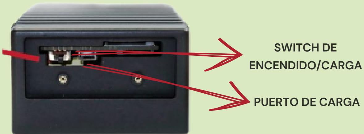
EL USUARIO DEBERÁ REMOVER LA TAPA PROTECTORA Y EL EMPAQUE PARA ACCEDER A LOS PUERTOS DE CARGA Y AL SWITCH DE ENCENDIDO Y CARGA
